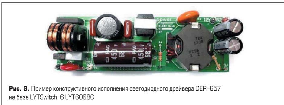
Рис. 9. Пример конструктивного исполнения светодиодного драйвера DER-657 на базе LYTSwitch-6 LYT6068C
