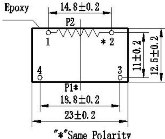
1、2pin: secondary output, 3、4pin: empty pin
