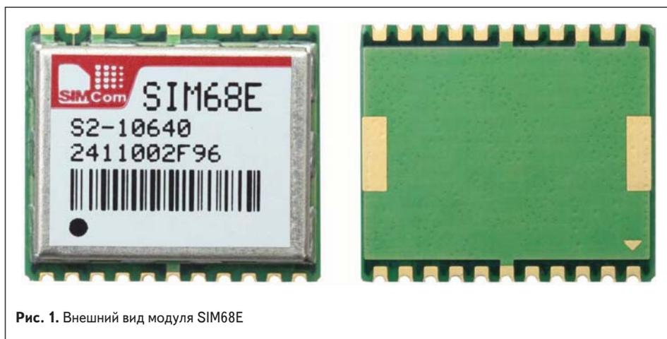
**Рис. 1.** Внешний вид модуля SIM68E
